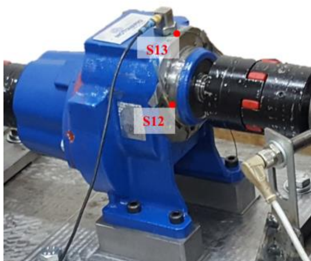
Крепление датчиков второго типа
